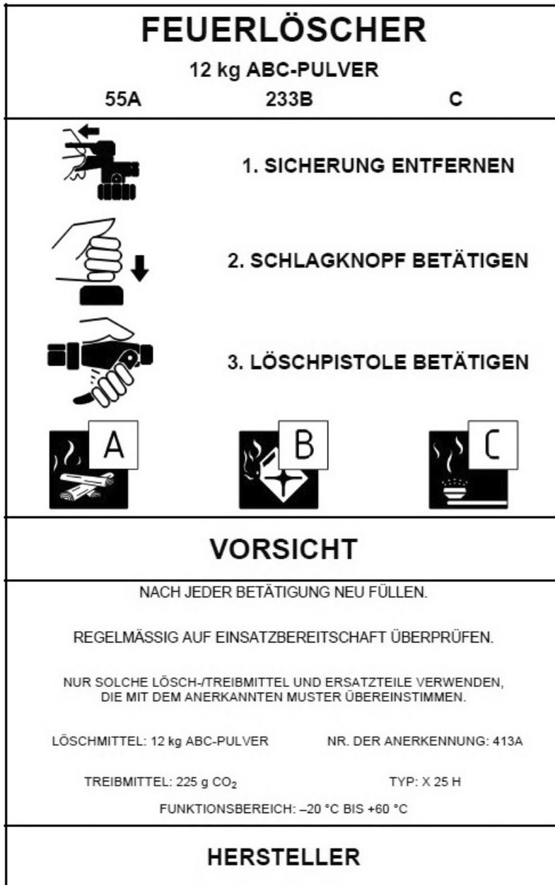
Bild G.8 — Beispiel für die Beschriftung eines TFL
